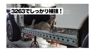
軽量化の為に部品全体的にバーリング加工!! 片側重量約3.9キロ ジャッキアップポイントの潰れ防止の補強に!! ボディ剛性UP!! オリジナルサイドシルインナーフォースメント3263!
